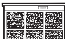
Filtro obstruido – reduce en gran parte el enfriamiento, la calefacción y el flujo del aire.
