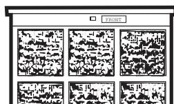
Filtro sucio – necesita limpieza
