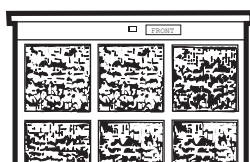
Filtre encrassé – Requiert un nettoyage
