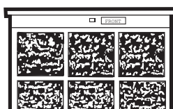
Filtre obstrué – Réduit considérablement le climatisation, le chauffage et la ventilation.
