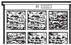
Filtre encrassé – Requiert un nettoyage
