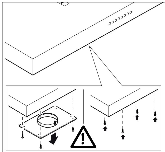
Introducir el módulo del ventilador desde arriba en la campana extractora. Sujetar con 4 tornillos.
