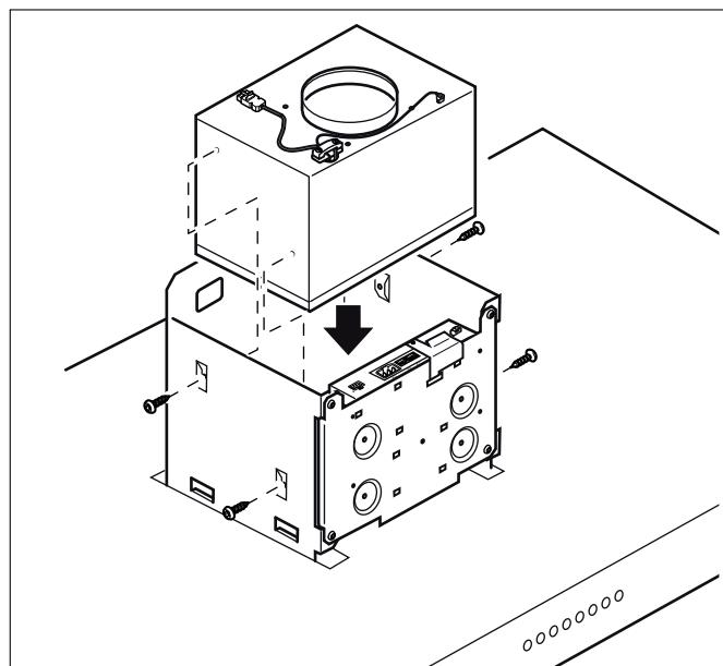
Conectar el cable de red y el cable de control al módulo de control.
