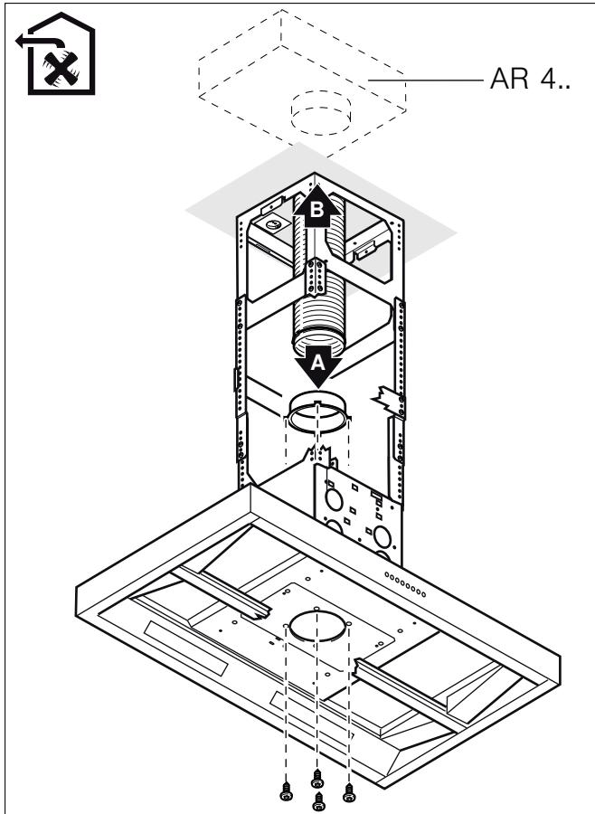
4 Establecer la conexión con la abertura de salida de aire (B).
