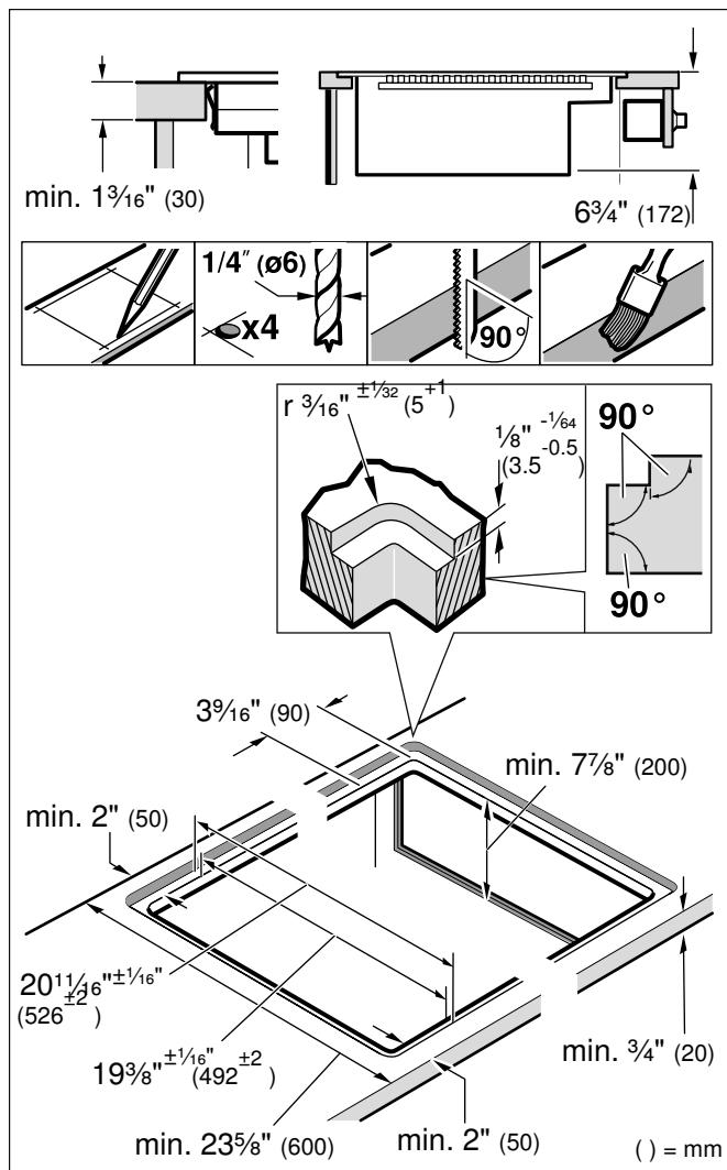
**Montaje a ras de superficie:** El aparato se puede montar en las siguientes encimeras resistentes a la temperatura y al agua:
