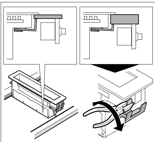
Insérer horizontalement l'appareil dans la découpe et ajuster. Serrer les tendeurs avec les vis situées à l'intérieur de l'appareil.
