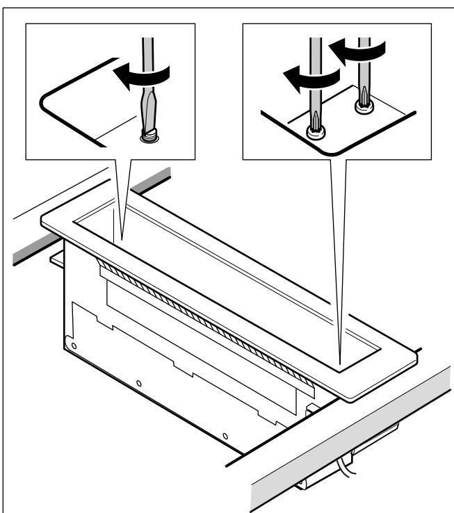
**3** Usar la ayuda de montaje. Introducir y alinear la ventilación de la tina en el hueco correspondiente. Quitar el elemento de cierre. Colocar la ayuda de montaje en diagonal en el hueco de ventilación y alinearla de forma vertical al equipo. Coloque el equipo en diagonal frente a la ventilación de la tina y presiónelo para introducirlo en el hueco con la ayuda de montaje. Retire la ayuda de montaje. Fijar la ventilación como se describió anteriormente.
