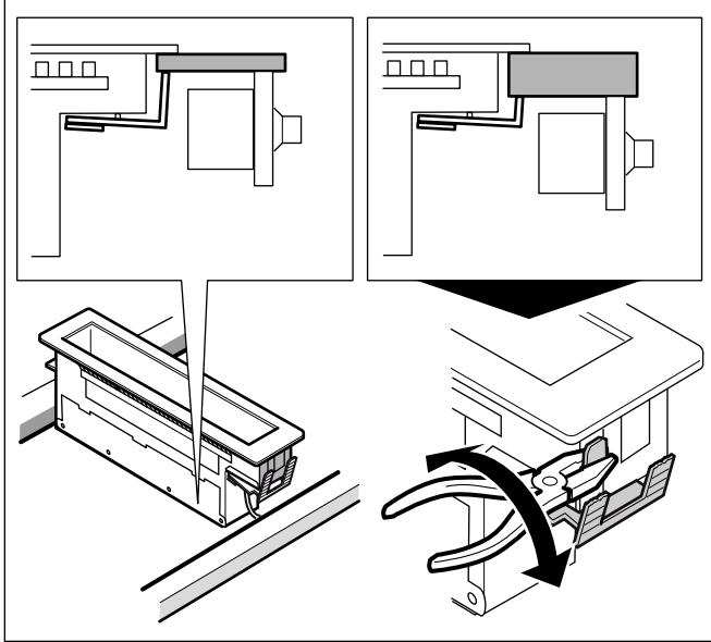
Insertar el dispositivo horizontalmente en el hueco y alinearla. Apriete el soporte de la tina con los tornillos en el interior de la unidad.
