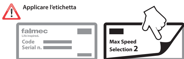
Fig. 2: Impostare massimo 2 velocità: Premere per 5 secondi i tasti + . Tutti i tasti lampeggiano. Entro 5 secondi, tenere premuto per 5 secondi il tasto . Se tutti i tasti si accendono fissi, l'impostazione è stata eseguita correttamente.
