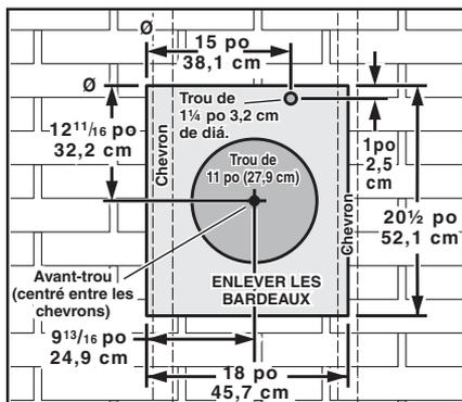
3. De l'extérieur, utilisez l'avant-trou comme point de départ pour tracer le plan d'installation :
