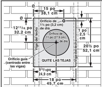
3. Desde el exterior, utilice el orificio guía como el punto de partida del diagrama de la instalación:
