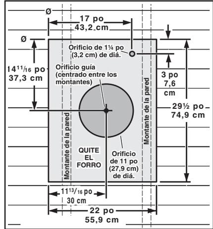
3. Desde el exterior, utilice el orificio guía como el punto de partida del diagrama de la instalación:
