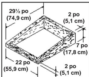
4. Pour une installation sur un toit plat, bâtissez un cadre qui permettra de monter le ventilateur selon une pente d'au moins  $\frac{2}{12}$ . La sortie du ventilateur sera dirigée vers le bas.
