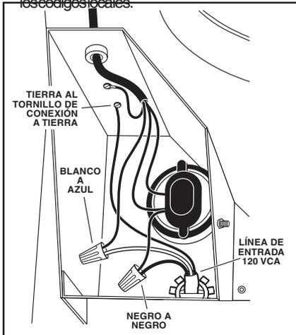
8. Haga las conexiones eléctricas utilizando el conector adecuado para el tipo de cables que está usando. Conecte el negro con el negro, el blanco con el azul y el verde o el alambre desnudo al tornillo de conexión a tierra.
