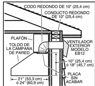
**INSTALACIÓN TÍPICA DE MONTAJE EN LA PARED**
