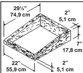
4. Para instalar un ventilador sobre un techo plano, construya un bastidor para soportar al ventilador, con una pendiente mínima de 2/12. El extremo de descarga del ventilador debe apuntar hacia abajo.
