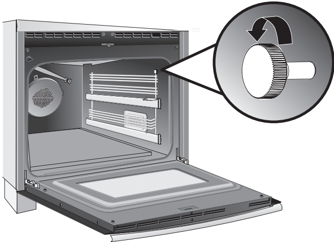
Figura 17: Tornillo de apriete del soporte de escalera
