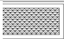
Pour assurer un rendement optimal : Remettre les filtres à graisses avec les ouvertures en demi-lune vers l'extérieur - et orientés comme illustré.
