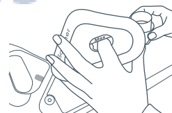
Dibujo 19 Para quitar el embudo del despachador del suavizante de telas.
