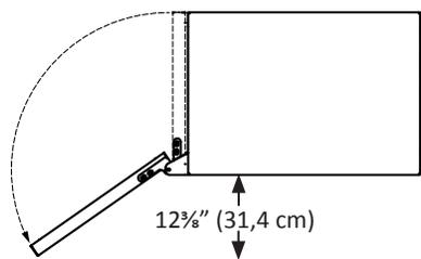
La porte doit être ouverte à cette dimension pour pouvoir enlever et/ou régler les profondeurs standard d'armoires
