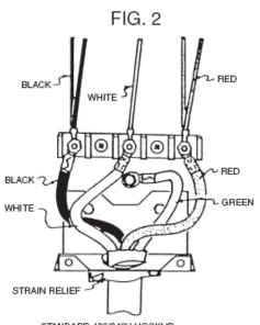
STANDARD 120/240V HOOKUP WHERE SEPARATE GROUND IS REQUIRED
